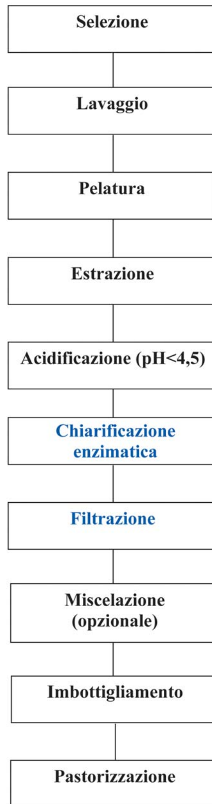
Fig. 2 - Flow sheet per la produzione di succo di fico d'India. Le operazioni unitarie riportate in blu si riferiscono al succo limpido. Fonte (vedi bibliografia), Sáenz (1998), Sáenz and Sepúlveda (1999).
