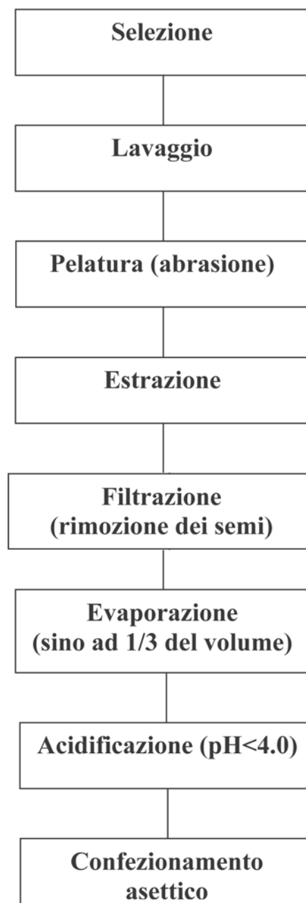
Fig. 3 - Flow sheet per la produzione di una purea di fico d'India. Adattata da (vedi bibliografia), Barbagallo et al. (1998).
